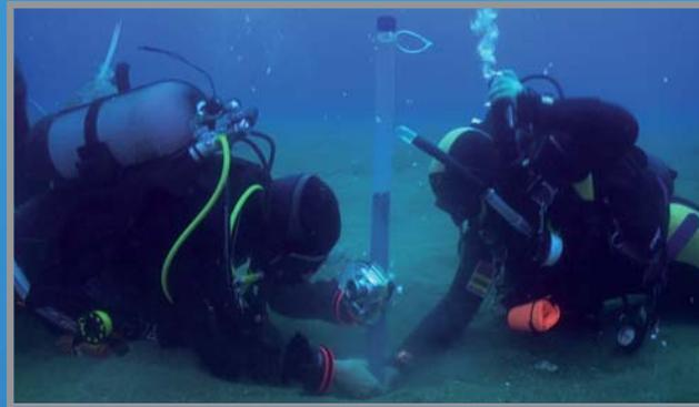
Prises d'échantillons sédimentologiques au moyen de liner-PVC pour examen de carottes de roches en vrac (SDC, 2011)
