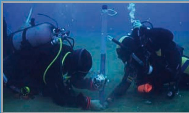
Sedimentologische Probenahme mittels PVC-Liner zur Untersuchung von Lockergesteinskernen (SDC, 2011)
